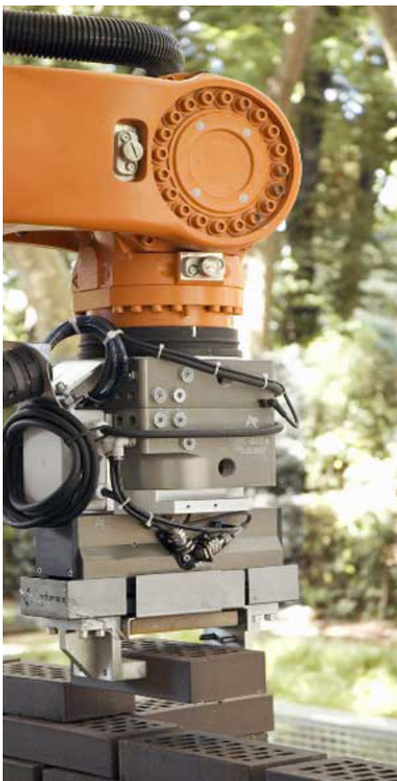
Fig.84 - Braço robótico a colocar tijolos, the Informed wall, Federico Augugliaro, Prof. Raffaello D'Andrea, 2012. (idsc.ethz.ch, 2017, 9)
