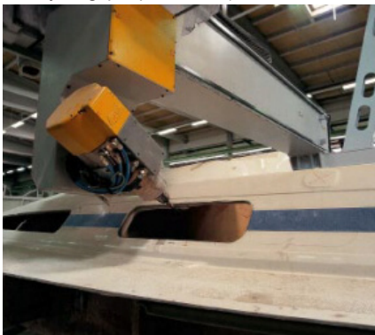
Fig.15 - Braços robóticos a cortar aberturas no casco da embarcação, Bavaria Yacht, 2017. ( sailingbreezes.com , 2107, 8)
