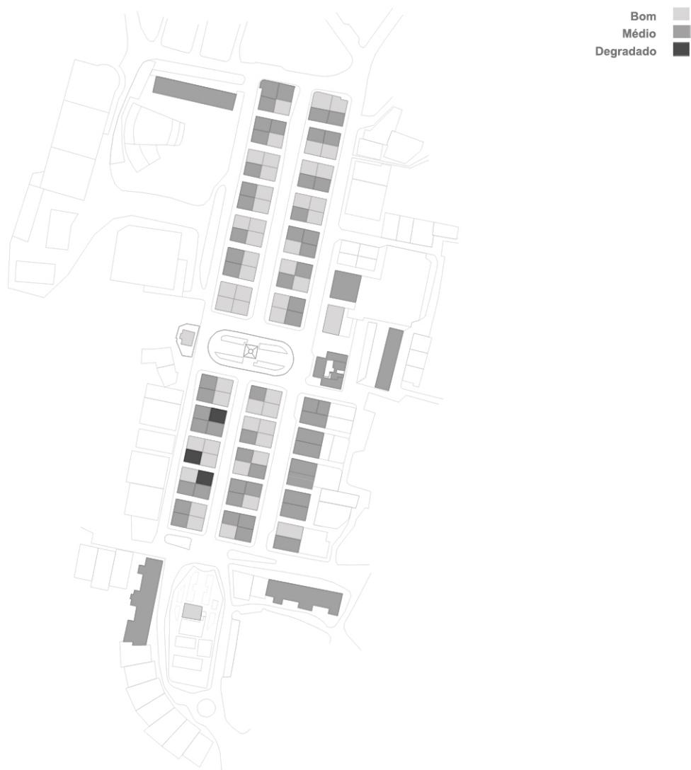
Fig.78 - Planta de Levantamento do estado de conservação das fachadas
