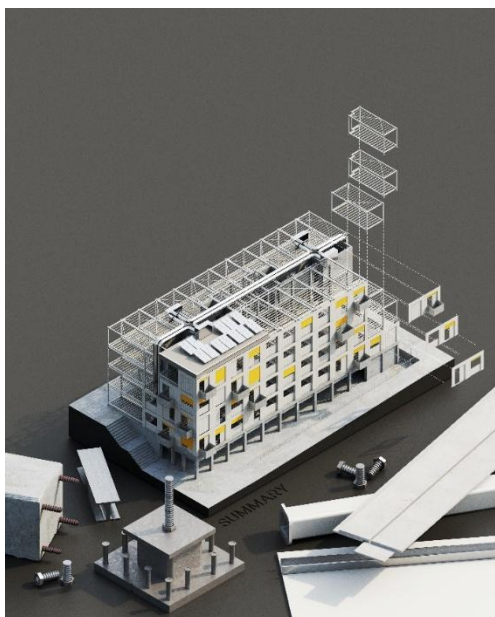
Figura 33 - Ilustração do princípio modular do conjunto de São Maçal com alusão às soluções mecânicas de união desenvolvidas, Imagem: Summary
