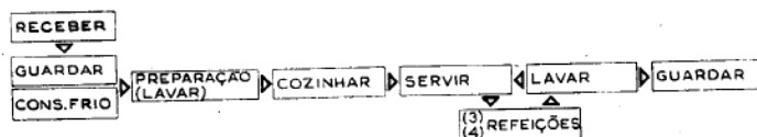
Figura 9 - Cadeia de operações do espaço de função 2 Alimentação-Preparação, Nuno Portas (Portas, 1969b)
